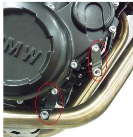
1. Befestigen Sie die Halter, wie auf den Bildern abgebildet, setzen Sie jeweils eine U-Scheibe M6 zwischen die Halter und den Motor.
