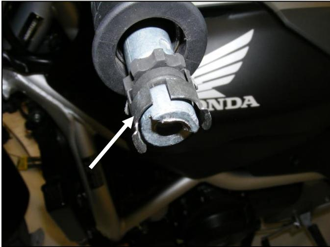
2. Montieren Sie nun die Halter in Fahrtrichtung links (2) in dem Sie zuerst den Spiegel demontieren, den Halter auf den Spiegeladapter auf legen und dann den Spiegel wieder aufschrauben und somit den Halter fixieren.
