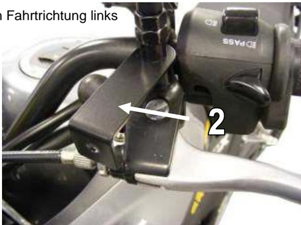
3. Demontieren Sie auf der Unterseite der Brems- und Kupplungshebels die Original-Mutter. Montieren Sie dann die Halter (2) an der Unterseite und befestigen Sie diese locker mittels der mitgelieferten M6 Muttern.
