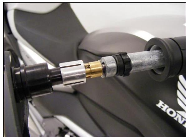
5. Richten Sie nun die Handprotektoren und die Halter zueinander aus und fixieren Sie die Handprotektoren mittels der Inbusschraube M6x18mm (4) und Mutter (5) an den Haltern. Prüfen Sie nun die volle Funktionsfähigkeit der Brems- u. Kupplungshebel und ziehen Sie dann alle Schrauben fest an.
