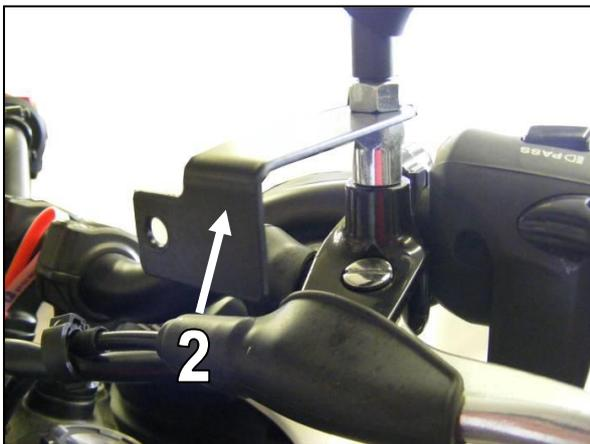
3. Montieren Sie nun die Halter in Fahrtrichtung rechts (3), in dem Sie zuerst den Spiegel demontieren, den Halter auf den Spiegeladapter auflegen und dann den Spiegel wieder aufschrauben und somit die Halter fixieren.
