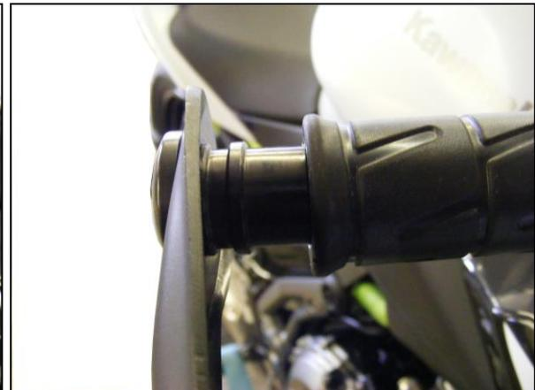
6. Richten Sie nun die Handprotektoren und die Halter zueinander aus und fixieren Sie die Handprotektoren mittels der Inbusschrauben M6x20mm (4) und Muttern (5) an den Haltern. Prüfen Sie nun die volle Funktionsfähigkeit der Brems- u. Kupplungshebel und ziehen Sie dann alle Schrauben fest an.
