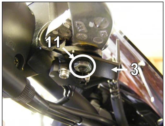
3. Demontieren Sie in Fahrtrichtung links den Spiegel vom Spiegeladapter und befestigen Sie dann den linken Halter (2) von oben auf dem Spiegeladapter, in dem Sie diesen durch montieren des Spiegels fixieren.
