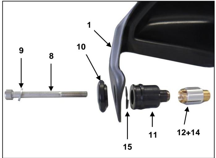
5. Schrauben Sie nun die Handprotektoren-Befestigung an das Original-Lenkergewicht und schieben Sie die gesamte Einheit fest in den Lenker.
