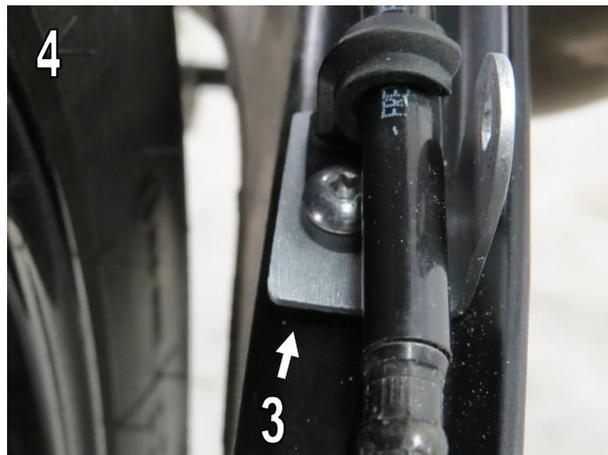
7. Befestigen Sie den Kantenschutz (9) an der Hinterradabdeckung (1) Abb.5/ *Fit edge trim (9) to Hugger (1) Fig.5*
