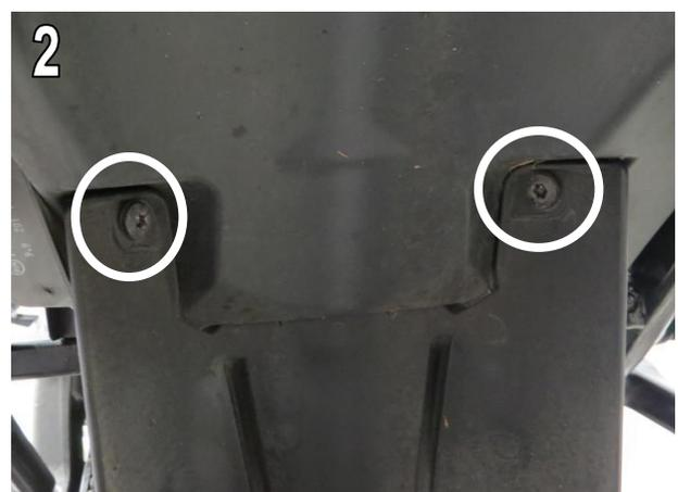
5. Befestigen Sie den linken Halter (2) auf der Schwinge mittels der originalen Schraube. Abb. 3 / *Fit left hand bracket (2) to the swing arm using the original screw. Fig. 3*
