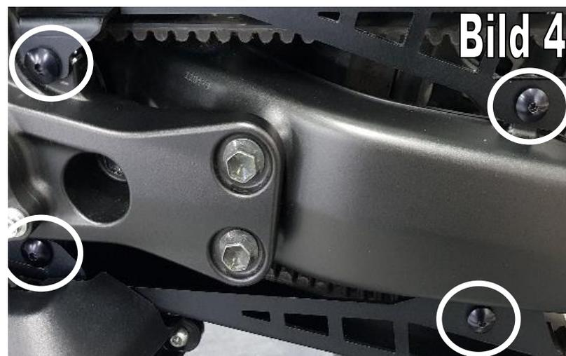
8. Setzen Sie die verbleibenden 2 Gewindeklemmen auf die Hinterradabdeckung und befestigen Sie diese an der oberen Riemenabdeckung mittels 2 M6x15 Schrauben und 2 Kunststoffunterlegscheiben Ø6 (siehe Bild 5+6)
