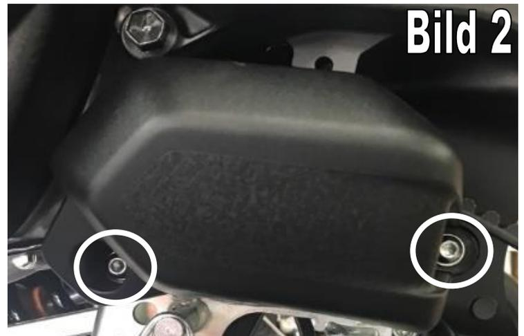
6. Entfernen Sie das hintere Teil der oberen Riemenabdeckung.
